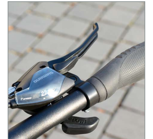
Perfekte Bedienung: breite Bremsgriffe, klasse indexierte, leicht agierende Schalthebel
