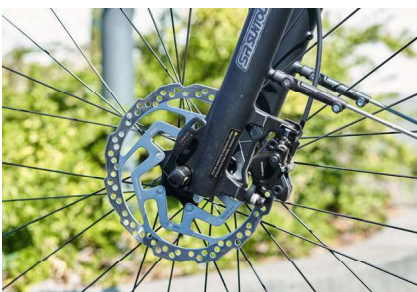
Auch am Intero tun Scheibenbremsen ihren Dienst – gewohnt bissig und gut dosierbar.
