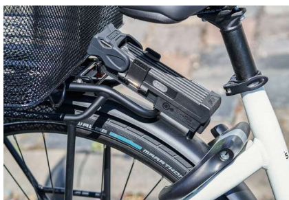
Der Magnethalter am Gepäckträger erlaubt unter anderem die Montage eines Abus-Faltschlusses...
