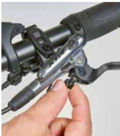
Diese kleine Schraube hat keinen Einfluss auf die Bremswirkung; hier kann der Abstand des Bremshebels zum Lenkergriff verändert werden.
