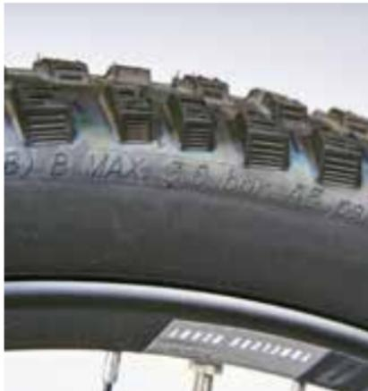
Auf allen Reifen zu finden: Minimaler und maximaler Luftdruck im Reifen.
