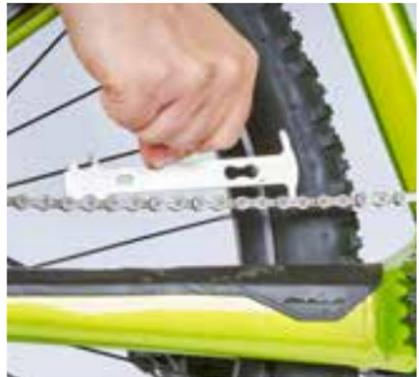
Eine Kettenlehre ist ein simples und nützliches Tool, das die Längung der Kette, also deren Verschleiß misst.
