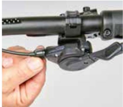
Über den Stellring am Schalthebel kann die Zugspannung erhöht werden.
