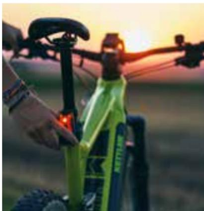
Die starken Leuchten werden am E-Bike aus dem Akku gespeist und sind schnell und sicher befestigt.
