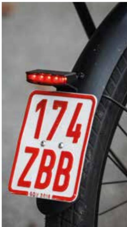
Haupterkennungsmerkmal eines S-Pedelecs ist neben dem markanten Rückspiegel ein Versicherungskennzeichen wie am Mofa.
