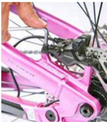
Wenn Bremsbeläge schleifen und quietschen, kann es sein, dass diese nicht exakt parallel zur Bremsscheibe sitzen; dann kann der Bremssattel dezent nachjustiert werden.
