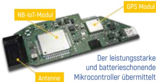
Der leistungsstarke und batterieschonende Mikrocontroller übermittelt die Position eines E-Bikes über Funk an die App.
