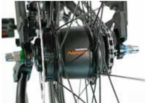
Schraubachse an einer Nabenschaltung.
