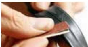
2. Dünn Vulkanisierflüssigkeit auftragen – Kleber großflächig verteilen!
