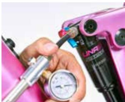
**Der angegebene Maximaldruck der Federelemente darf NICHT überschritten werden!**
