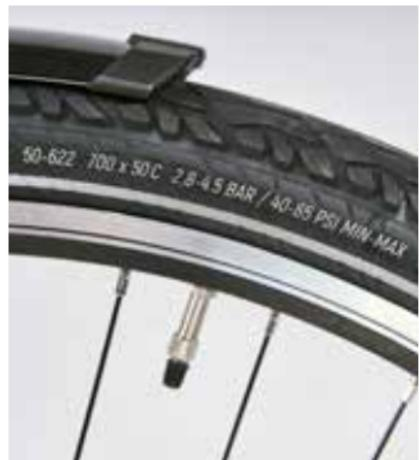
An der Seitenwand eines Reifens befinden sich verschiedene Größenangaben.
