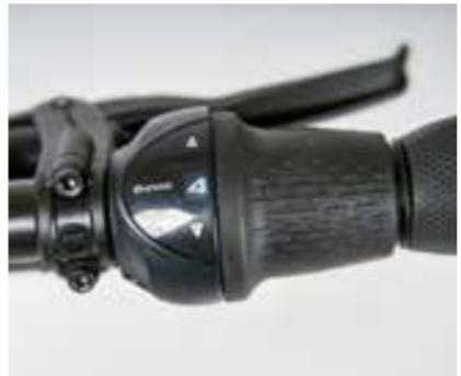
Häufig werden diese mit praktischen Drehschaltgriffen kombiniert.
