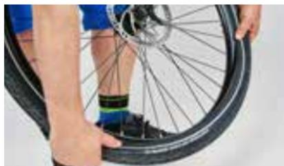
Einen neuen oder reparierten Schlauch einsetzen, leicht mit Luft befüllen und vorsichtig einlegen.
